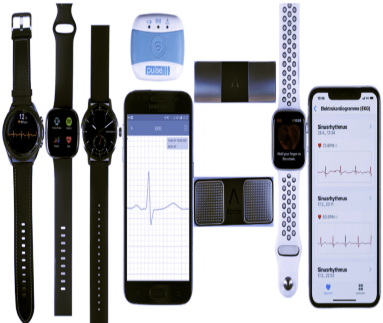
Fig. 3: dispositivi indossabili in grado di registrare l'ECG.
